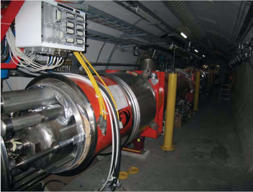
Слика 6. Део прстена LHC-а са једним диполним магнетом у завршној фази инсталације и тестирања у близини експеримента CMS (Cessey, Француска).
